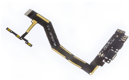
Flex com conector de carga, microfone para BQ Aquaris M5
