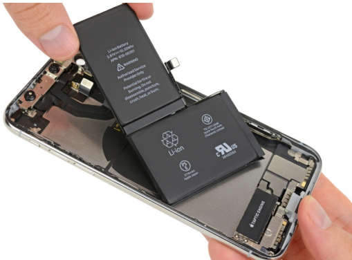
iPhone 11 Pro Substituição da Bateria
