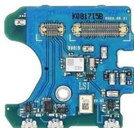
Placa auxiliar para Samsung Note 20 com microfone e antena
