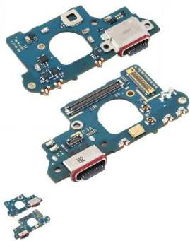
Samsung S20 FE Substituição da Placa de Carga
