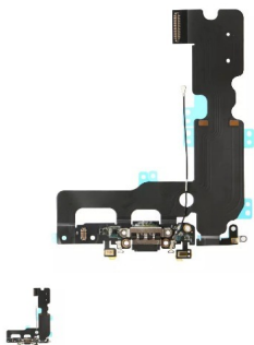
iPhone 7 Plus Substituição de módulo de carga
