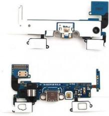
Flex com conector de carga e acessórios para Samsung Galaxy A5 A500F
