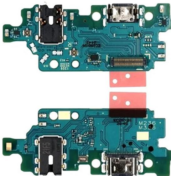
Flex de carga para Samsung A23 5G 2022 A236B PCB
