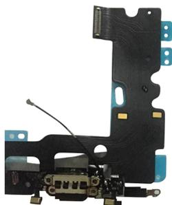
iPhone 7 Substituição de módulo de carga
