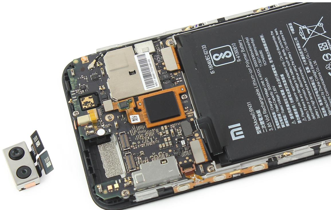
Xiaomi Mi A1 Substituição da Bateria
